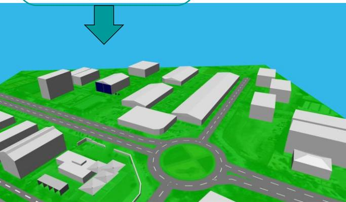
根据项目图纸等资料，建立室外噪声模型。
